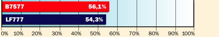
Испытание методом Cummins 10547: мягкий режим C2A, жидкость RM99, 82оС. Средневзвешенная во времени эффективность.
