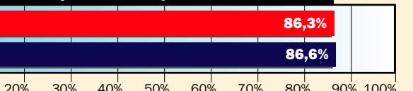
Испытание методом SAE J905: расход 341 л/ч, контрольная тонкодисперсная пыль компании РТ, скорость накопления пыли 4 г/2 г, конечный перепад давления 27,5 кПа. Средневзвешенная во времени эффективность.
