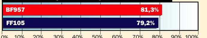
Испытание методом SAE J905: расход 341 л/ч, контрольная тонкодисперсная пыль компании РТ, конечный перепад давления 27,5 кПа. Средневзвешенная во времени эффективность.
