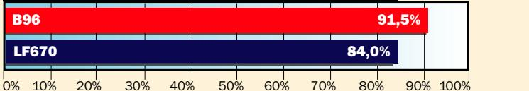
Испытание методом SAE HS806: расход 78 л/мин, контрольная тонкодисперсная пыль компании РТ, скорость накопления пыли 5 г/ч, конечный перепад давления 192,5 кПа. Средневзвешенная во времени эффективность.
